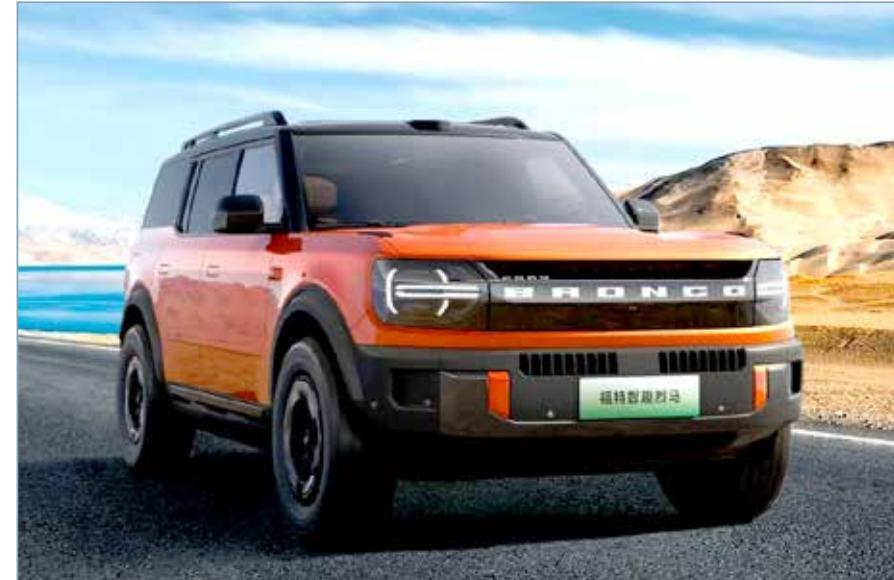
EREV tem motor 1.5 de 150 cv que gera energia para as baterias BYD Blade de 43,7 kWh. São 220 km de autonomia. O alcance misto chega a 1.220 km.
