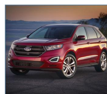
Motor antigo Plataforma (a mesma do Fusion) e tecnologias podem ser novas, mas o motor do Edge continua a ser o velho 3.5 V6, a gasolina, de 284 cv, acoplado à também conhecida transmissão automática de seis velocidades, com opção de trocas manuais via aletas atrás do volante. Tração será sempre integral.
