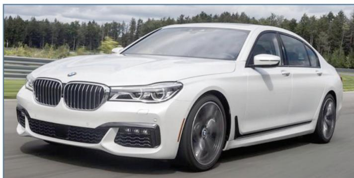
No Brasil, o sedã terá apenas a opção do motor V8, enquanto no exterior também existe o 6 cilindros. Combinado com transmissão automática de 8 velocidades, o V8 de 4,4 litros rende 450 cavalos de potência e 650 nm de torque máximo.
