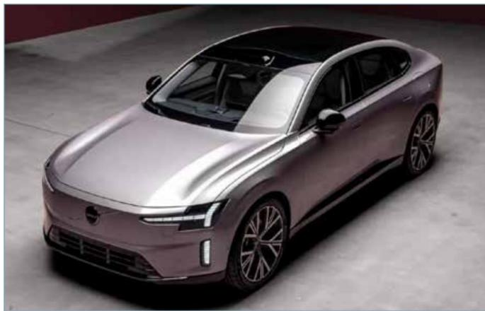
com o novo sistema elétrico de 800 volts. A configuração mais simples tem motor de 329 cv e 48,9 kgfm de torque com um 0-100 km/h de 6,6 segundos. Já a versão mais forte tem 680 cv e um 0-100 km/h de 4 segundos. Segundo informações do site oficial da Volvo, o ES90 pode adicionar 300 quilômetros de alcance em apenas 10 minutos em estações de carregamento rápido de 350 kW. **Volvo com bons números:**
