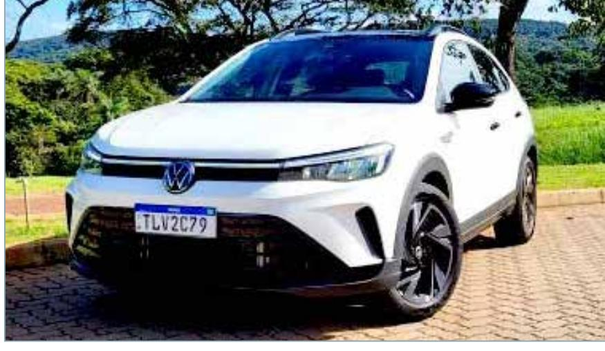
4,27 metros de comprimento, 1,75 m de largura e 1,49 m de altura. A distância entre-eixos é de 2,56 m, a mesma do Polo, com quem compartilha a plataforma MQB-A0. O porta-malas de 415 litros é um dos pontos fortes do modelo no segmento. Ele supera rivais diretos como o Fiat Pulse. O compartimento é bem acabado, com iluminação, banco traseiro bipartido e estepe temporário de tamanho razoável.
