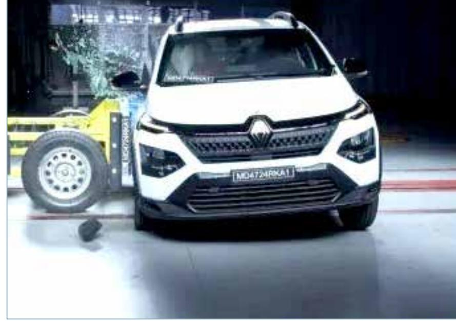
83,78% em assistência à segurança. O teste de impacto frontal demonstrou comportamento estrutural estável, mas com área dos pés classificada como instável. Em proteção ao peito,
